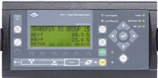
该系统用于控制电站的液体燃料供给，DEIF 燃油控制器（AFC PM）是一个自动化的、安全可靠的创新型控制解决方案。基于控制众多小型分散油罐，而不是一个大的中央油罐的理念，AFC PM 解决方案能够让您更灵活和机动地移动和调试您的机组和燃料箱。
