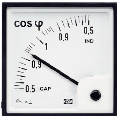
El medidor de factor de potencia PFQ mide el coseno de  $\phi$  con el movimiento de una bobina móvil y un transductor electrónico. El transductor mide el ángulo de desfase entre la tensión AC y la correspondiente intensidad AC, convirtiendo la señal en una intensidad en corriente continua (DC) proporcional que, acto seguido, se alimenta al instrumento de bobina móvil.
