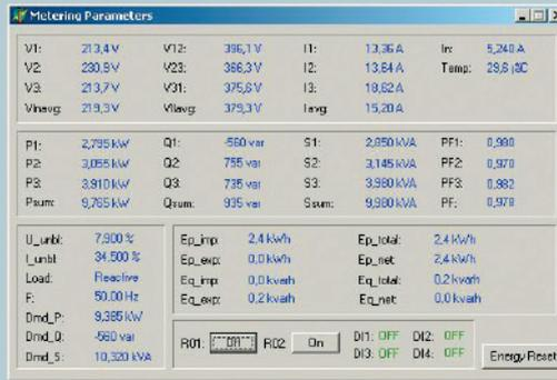
Kostenlose Utility-Software für die einfache Programmierung des Gerätes und für die (Fern-) Ablesung der gemessenen und berechneten Werte.
