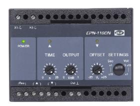
ポテンショメーターはPIステップコントローラーの継電器出力を調速機/AVRの制御電圧に変換します。これには、DEIFの負荷分散ユニットタイプLSU、DEIFの同期タイプFAS、または継電器付きPIステップコントローラーのその他のタイプが含まれます。
