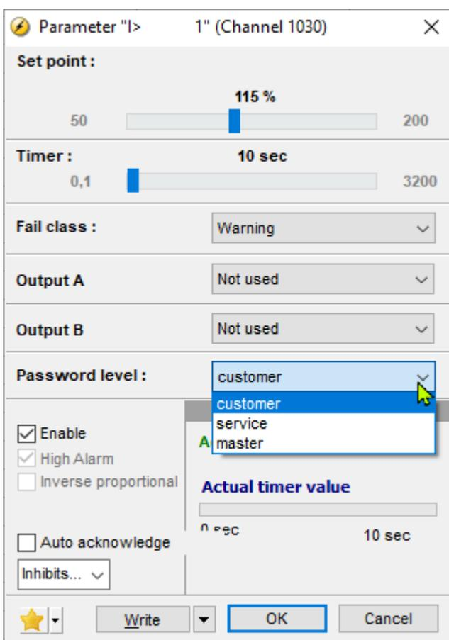
密码等级还可以在“Level”列的密码视图中进行修改。右键单击该字段，选择“Change access level”，然后选择所需的密码等级。
