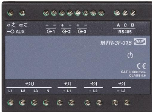
De la taille d'un disque dur de portable, les transducteurs de type MTR-3 sont compacts mais accomplissent le travail de quatre transducteurs standard : mesure et calcul de la tension AC, intensité AC, puissance active / réactive / apparente, facteur de puissance, fréquence, kWh, kVar, THD, demande dynamique et maximale.
