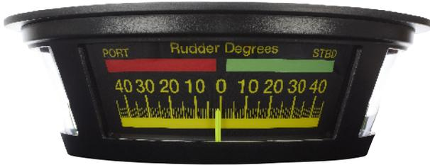
El TRI-2 se emplea para indicación de la posición del timón en el puente. Este indicador consta de un robusto sistema de bobina móvil equipado con 3 agujas montadas sobre un eje común. Es idóneo si necesita una entrada analógica. Para entrada para bus CAN, consulte el TRI-2 con interfaz CAN.
