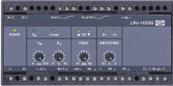
DEIF의 Uni-line 부하 공유 장치, LSU-113DG는 발전기 사이의 역전력 보호 및 저전력 감지를 포함하여 부하 공유를 제공하며, 전자 전위차계(EPQ96-2 또는 EPN-110DN)를 통해 거버너에 연결됩니다.
