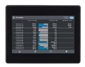
AGIは複数のアプリケーションを視覚化してアクティブ制御する、直感的に使えてユーザーフレンドリーなHMIとして設計されました。4.3インチと15インチのサイズ、直射日光下や鋭い角度からでも読み取り可能な高品質画面で用意されており、ブリッジ計装設置に安全かつ最適な選択です。
