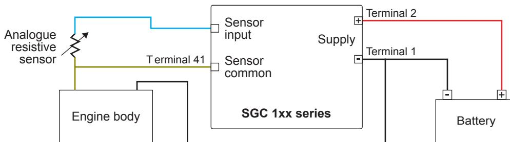
\*模拟量输入 2 的 SCP 连接, 用作燃油液位传感器, 参考配置为电池负极
