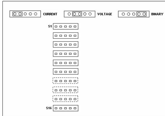
Se debe configurar la dirección de E/S para el bus del panel posterior. Observe que todos los módulos IOM 4.1 deben tener direcciones de E/S diferentes comenzando a partir de cero. La dirección de E/S se configura con el selector de dirección de E/S.
