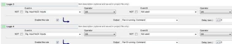
Der Ausgang „Lüfter A/B/C/D läuft-Befehl“ informiert den AGC-4-GER darüber, dass der Lüfter läuft. Der Ausgang ist unter Ausgang und Befehl zu finden, wie im Screenshot oben dargestellt.
