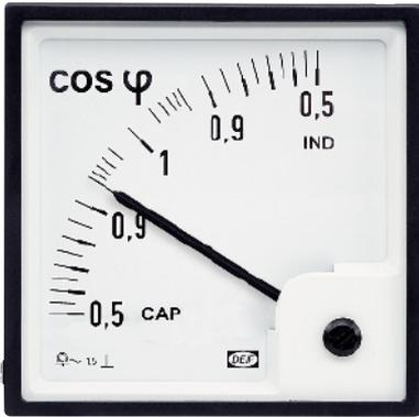
PFQ 功率因数表使用动圈式移动和电量变送器，变送器测量交流电压和对应的交流电流间的相位角，把信号转换成比例直流电流，然后再送至动圈式仪表。
