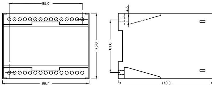
Das LMR-111D ist für den Schalttafelbau vorgesehen, entweder an einer 35 mm DIN Schienen oder mittels 2 Stück 4 mm-Schrauben montiert.
