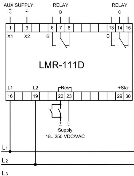
Der Hilfsspannungsanschluß kann durch eine 2A Sicherung geschützt werden.
