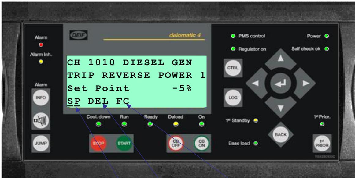
Jede Schutzoption verfügt über einen Sollwert (SP), einen Timer (DEL) und eine Fehlerklasse (FC), die innerhalb von Grenzwerten konfiguriert werden können. Alle Parameter sind passwortgeschützt, um eine Änderung der Einstellungen durch unbefugtes Personal zu verhindern.
