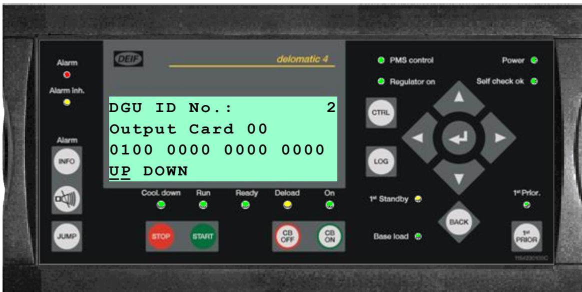
Der Binäreingang für Kanal 0 wird mit der ersten Stelle von links angegeben. Ein niedriger Status wird durch 0, ein hoher Status durch 1 angegeben. Wurde ein analoger Eingangskanal ausgewählt, wird er durch A angezeigt.
