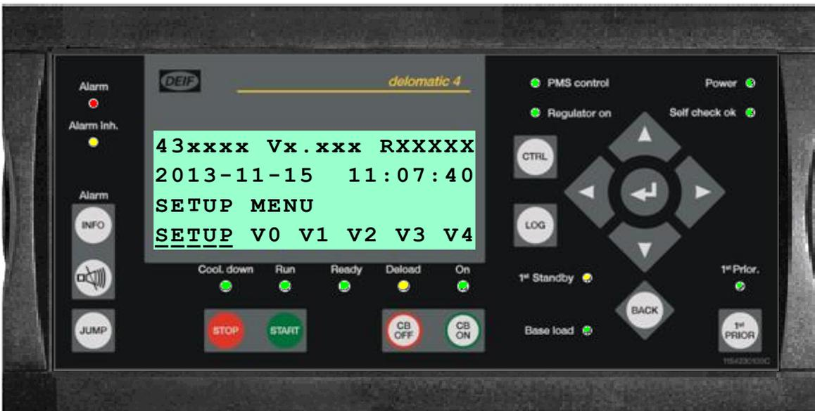
Im oben abgebildeten Fenster sind in der ersten Zeile die Projektnummer, die Softwareversion und die Ausgabe, in der zweiten Zeile Datum und Uhrzeit und in der dritten Zeile der Text SETUP-MENÜ zu sehen. In der vierten Zeile können Sie das SETUP-MENÜ oder V0-V4 auswählen.
