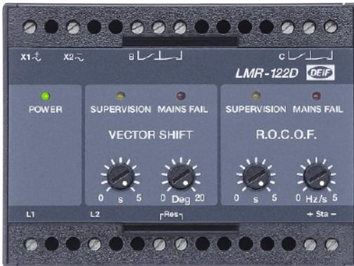
Le relais Uni-line de perte de secteur LMR-122D assure la protection du générateur contre les dommages causés par une reconnexion non-synchronisée au réseau après une perte de secteur temporaire.
