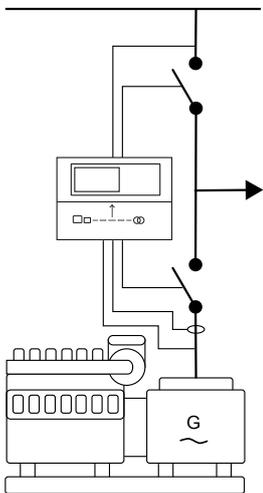
如果主发电系统严重短缺或完全断电，控制器会自动更改对应急发电机的供电。这能够确保故障期间的正常供电并防止对电气设备造成的损坏。
