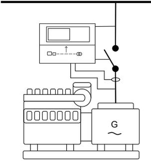
独立控制器（孤岛模式运行）通常用于与其他发电系统隔离的电站。
