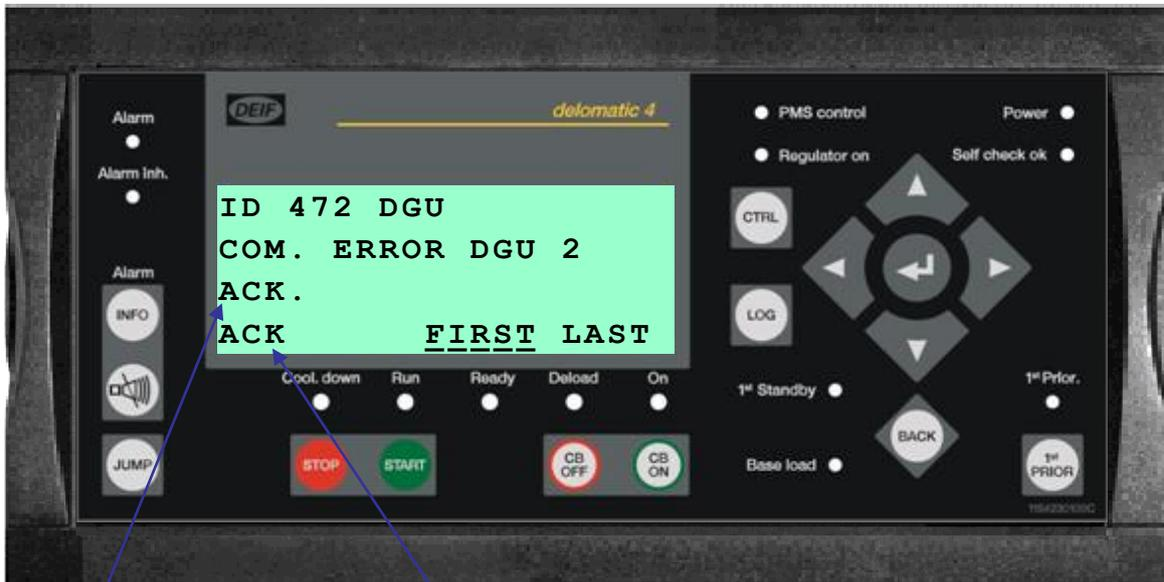
显示面板中的 ACK 状态行 应答时，ACK 的下划线必须处于激活状态
