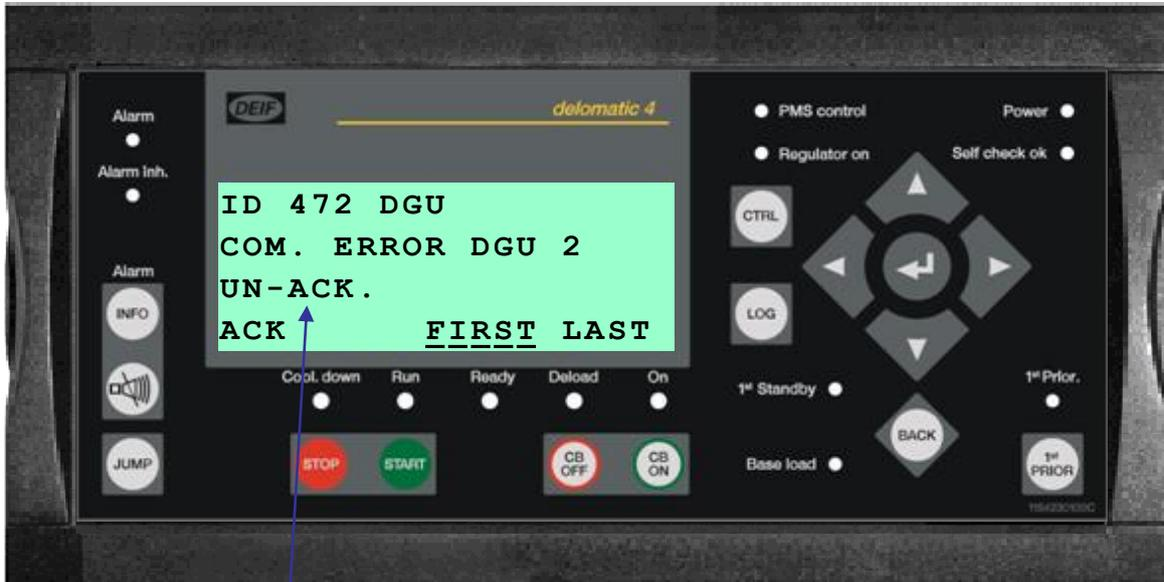
显示面板中的 UN-ACK 状态行
