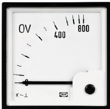
Le voltmètre différentiel NEQ est un instrument à fer mobile calibré pour avoir une pleine échelle de deux fois la tension nominale du réseau, tandis que 2/3 de la pleine échelle correspond à la tension nominale du réseau.
