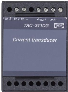
強力、迅速、コンパクトなDEIFのトランスデューサー製品ラインのユニットは、正弦波交流電圧や電流信号を測定し、PLC、PC、マイクロプロセッサー制御、インジケーター、アラームユニットなどに対して、測定に比例する直流または電圧信号として出力信号を発します。
