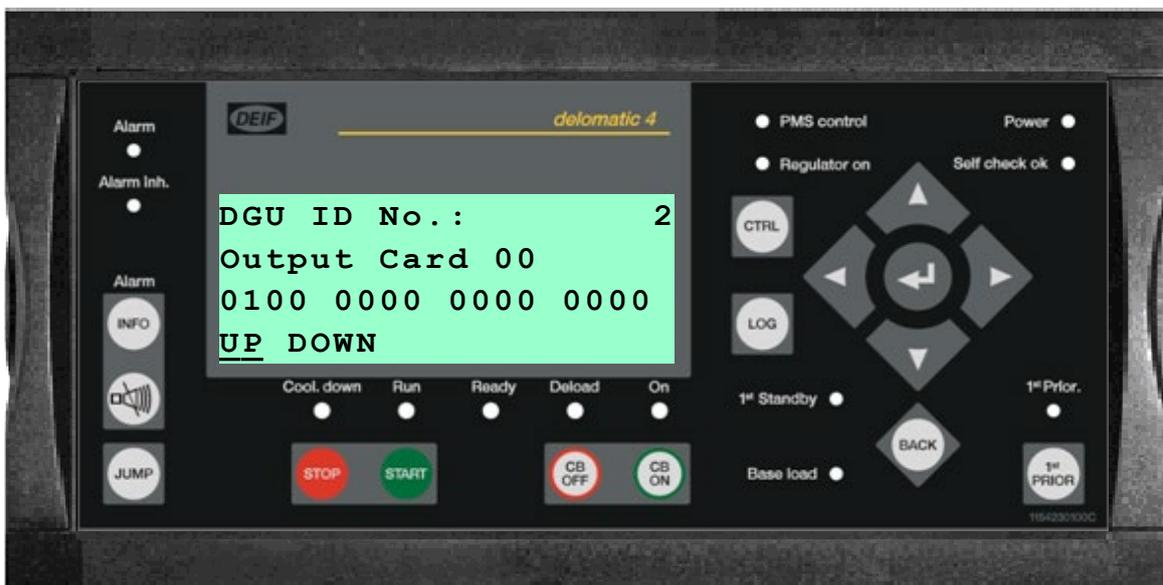
La entrada binaria para el canal 0 se indica como primer dígito visto desde la izquierda. Un estado bajo se indica con un 0, un estado alto se indica con un 1. Si se ha seleccionado el canal de entrada para analógico, se indica con una A.
