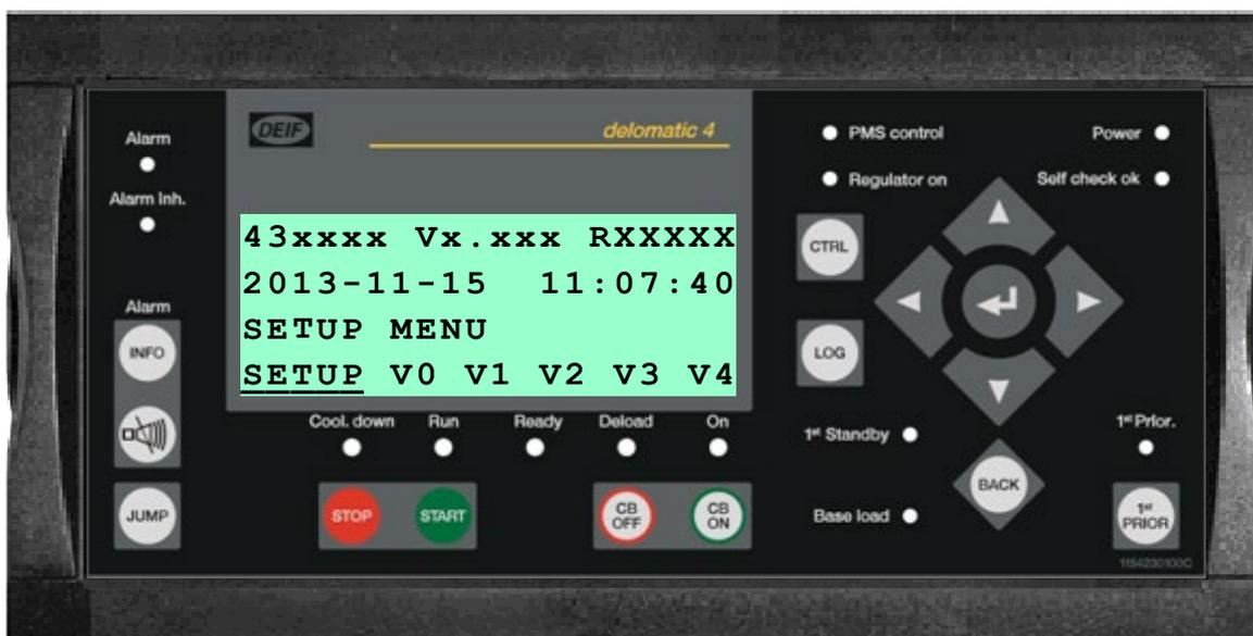
La ventana superior muestra el número de proyecto, la versión de software y el número de edición en la primera línea, la fecha y la hora del reloj en la segunda y el texto SETUP MENU (MENÚ DE CONFIGURACIÓN) en la tercera línea. En la línea cuatro, es posible seleccionar el menú de configuración (SETUP) o V0-V4:
