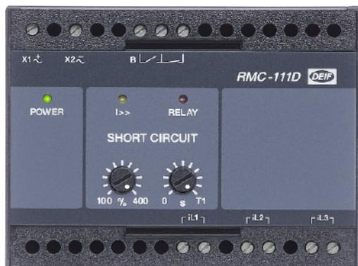
Los relés de intensidad y de cortocircuito RMC de DEIF se emplean en aquellos casos en los cuales se requiere solo la protección de intensidad ( $I>>$ ) o contra cortocircuito.
