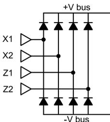
交流电源端子可连接到交流发电机端子 (SHUNT)、永磁发电机 (PMG)、辅助绕组励磁 (AREP) 或外部电源。
