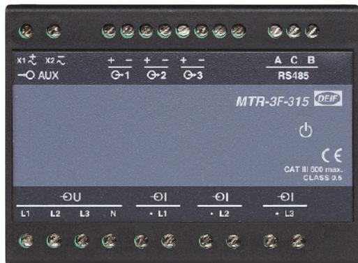
MTR-3 变送器只有移动硬盘的大小，但功能强大，1 个 MTR-3 变送器相当于 4 个标准变送器的作用，能够测量并计算交流电压、交流电流、有功/无功/视在功率、功率因数、频率、kWh、kVar、THD 等，可满足动态和最大需求。
