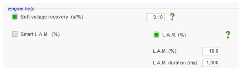
Quando a frequência medida do gerador é menor que o joelho de subvelocidade especificado na configuração (por exemplo, 48 Hz ou 57 Hz), o ponto de ajuste da tensão é diminuído para um valor especificado (no exemplo acima, 10% abaixo da tensão nominal) .
