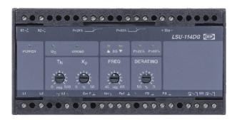
DEIF의 Uni-line 부하 공유 장치, LSU-114DG는 발전기 사이의 자동 시작/정지 출력 포함 부하 공유를 제공하며, 전자 전위차계(EPQ96-2 또는 EPN-110DN)를 통해 거버너에 연결됩니다.
