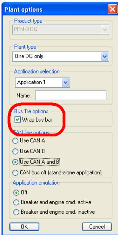
为允许母排上的闭环连接，将参数 8990 (Closed Ring) 选为 ON。
