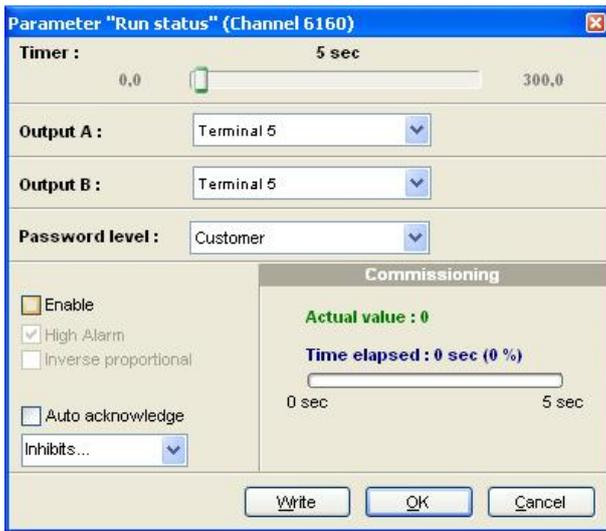
在输出 A 和输出 B 中选择正确的继电器编号，启用该功能。在 I/O 菜单中将继电器功能更改为限制。随后继电器激活，但不会出现任何报警。
