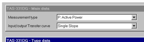
Single Slope ist die Standardkurve des Ausgangssignals. Sie können sowohl vor als auch während der Programmierung der Daten die Kurve auf Dual Slope oder Triple Slope umstellen.
