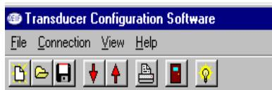
Auf Connection klicken und den Port wählen, an den der "USB to TTL converter" angeschlossen ist (My Computer, View system information, Hardware-Tab und Device Manager).
