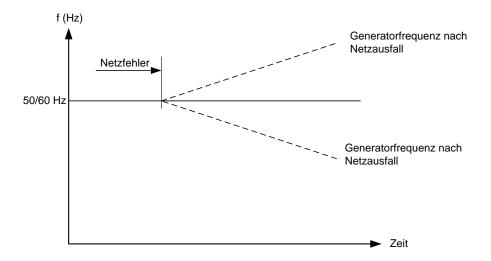
Somit ist eine dramatische Frequenzänderung ein Netzausfall. Die Einstellung erfolgt in Hz/s.
