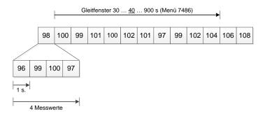
Die Zahlen stellen die Sammelschienenspannung (in %) des Nennwertes dar.
