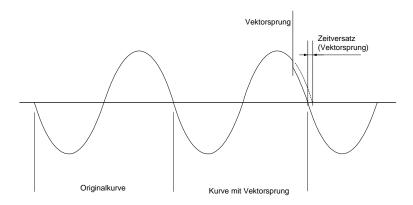
Der Vektorsprung wird durch Zeitmessungen der Halbwellen und Vergleich mit vorhergehenden Messungen festgestellt.
