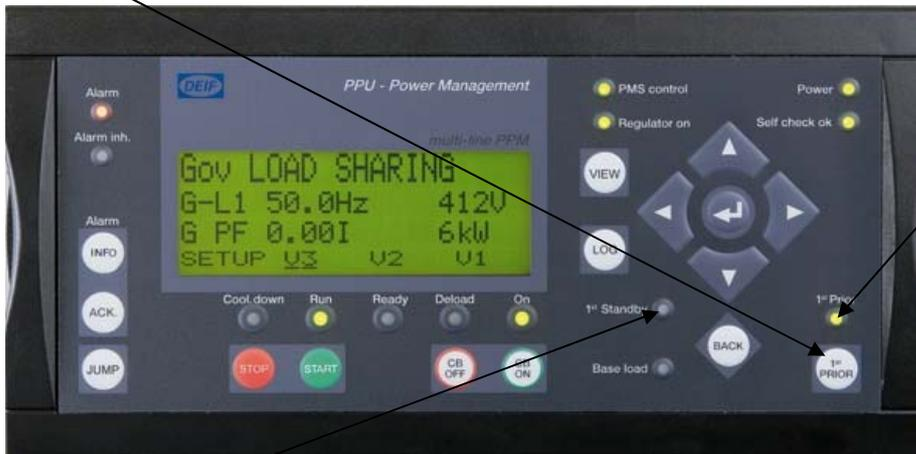
Die LED der 1<sup>st</sup> PRIOR-Taste leuchtet auf dem Gerät, dessen Generator die erste Startpriorität zugeordnet wurde.
