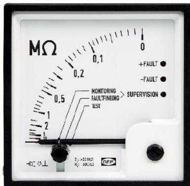
Les contrôleurs de la gamme SIM-Q sont utilisés pour la surveillance de la résistance d'isolation entre un réseau de distribution de tension isolé et un câble de sécurité / de mise à la terre. La séquence de mesure avancée effectue un décalage automatique pour éliminer les effets possibles d'une capacité parasite et de tensions DC déséquilibrées.
