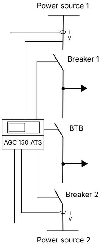
3 断路器配置用于有两个电源和两个负载点的情况。它可用于中压 ATS 系统，如数据中心。电源 1 或两个电源都可被设为主电源。
