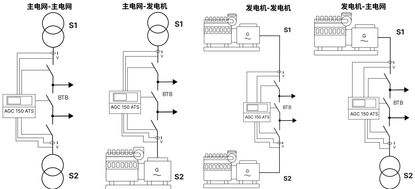
**备注** 显示屏上的模拟盘会根据所选电源的不同而有所不同。例如，主电网/发电机应用的模拟盘与发电机/主电网应用的模拟盘是不同的。有关更多信息和示例，请参阅 **AGC 150 ATS 设计手册**。
