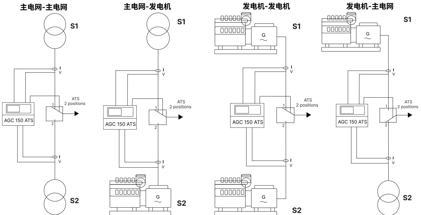
**备注** 显示屏上的模拟盘取决于所选的电源。例如，主电网/发电机应用的模拟盘与发电机/主电网应用的模拟盘是不同的。有关更多信息和示例，请参阅 **AGC 150 ATS 设计手册**。
