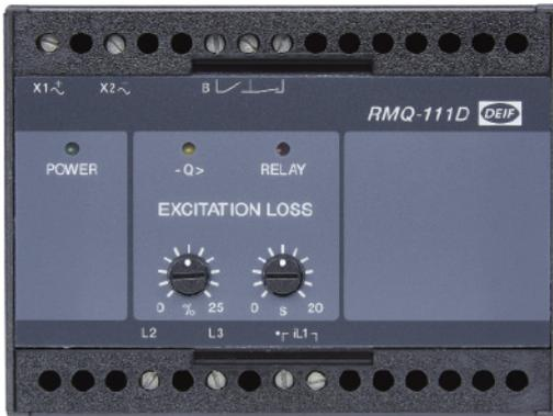
Ce relais Uni-Line empêche un générateur tournant en parallèle avec d'autres générateurs de tourner comme un générateur asynchrone à cause de la sous-excitation - particulièrement quand l'utilisation d'un relais de sous-excitation s'avère insuffisante.
