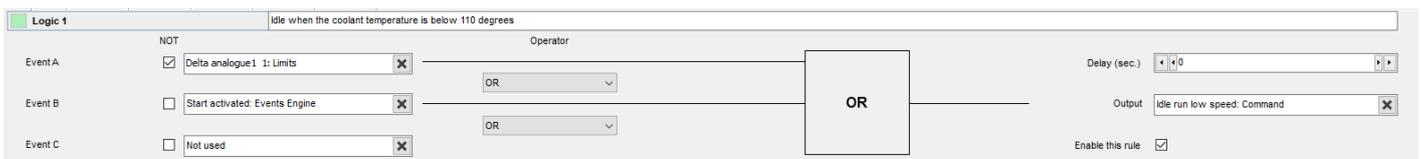
Para que esta función funcione correctamente, debe estar habilitado el menú 6295 Ralentí activo y la salida de relé debe estar configurada. En caso contrario, la función de baja velocidad no funcionará.
