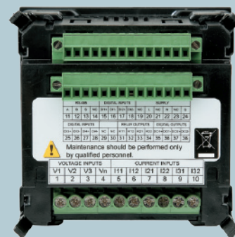
Lette tilgjengelige tilkoblings terminaler, og fastspenningsklemmer uten skruer, gjør at installasjonen i tavlen går raskt.
