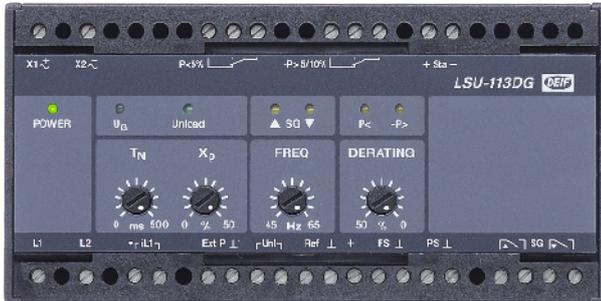
DEIFのUni-line負荷分散ユニットLSU-113DGは、逆電流保護と低電力検出を含む負荷分散を発電機間で行い、電子ポテンシオメーター（EPQ96-2またはEPN-110DN）から調速機へのインターフェイスを提供します。
