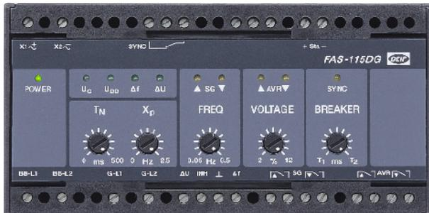
Le synchroniseur FAS-115DG sert à synchroniser un générateur avec le jeu de barres et à fermer son disjoncteur lorsque l'écart de tension, la fréquence de glissement et les angles de phase sont compris dans les limites prédéfinies. De plus, ce synchroniseur peut effectuer la régulation de la tension.
