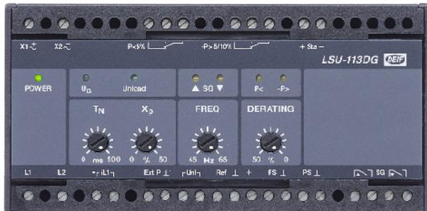
Le répartiteur de charge LSU-113DG de la gamme Uni-Line de DEIF assure la répartition de charge entre générateurs, avec protection contre le retour de puissance et détection puissance faible, et s'interface avec un régulateur à travers un potentiomètre numérique (EPQ96-2 or EPN-110DN).
