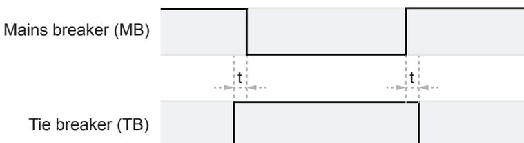
Wenn der Kuppelschalter geschlossen ist, wird der Netzschalter automatisch geöffnet, bevor der Timer abläuft (t). Wenn der Netzschalter geschlossen wird, wird der Kuppelschalter geöffnet, bevor der Timer abläuft (t). Der Timer ist konfigurierbar (0,10 bis 99,90 Sekunden).
