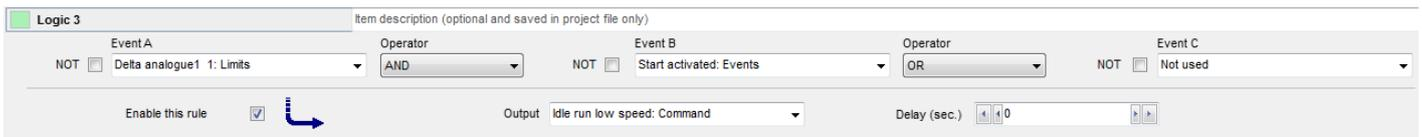
Pour que cette fonction puisse être utilisée, **6295 Idle active** doit être activé, et la sortie relais doit être configurée. Sinon la fonction basse vitesse est inopérante.
