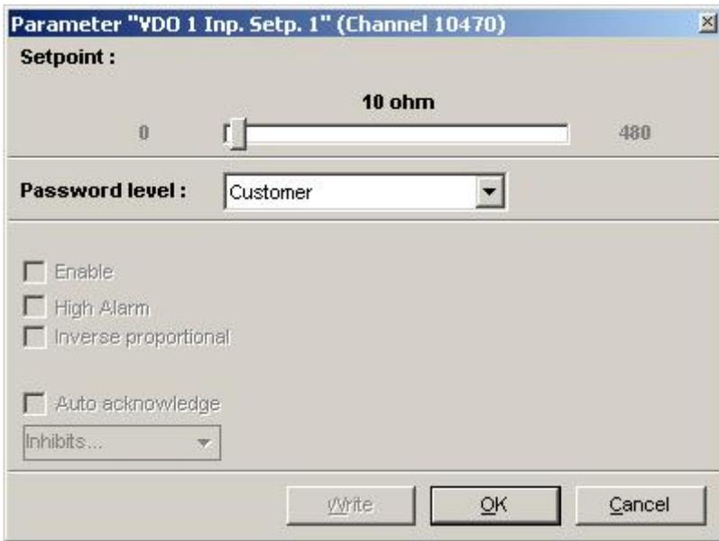
Régler la résistance de la sonde RMI à la valeur de mesure précise souhaitée. Ci-dessus, le réglage est de 10Ω à 0.0 bar.
