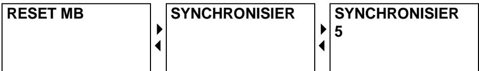
Die Synchronisierung eines Zeitintervalls wird ausgeführt, indem die Taste gedrückt ist und ein Rückwärtszählen von 5 bis zu 0 Sekunden gemacht wird. Wenn die Taste für weniger als 5 Sekunden gedrückt ist, wird die Synchronisierung des Zeitintervalls nicht ausgeführt. Nach der Synchronisierung wird "Zeit/Periode" im Display angezeigt. Damit ist die Synchronisierung ausgeführt und eine neue Messung angefangen.
