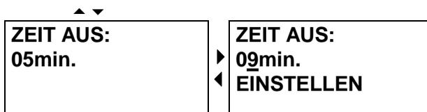
Die Dauer der Hintergrundbeleuchtung wird im Bereich 0 bis zu 54 Minuten eingestellt. Die Hintergrundbeleuchtung wird bei Aktivierung einer der 4 Tasten unter dem Display angeschaltet und wird wieder ausgeschaltet, wenn die Einstellungszeit nach der letzten Aktivierung einer Taste abgelaufen ist. Wenn "Zeit aus" auf 0 eingestellt ist, wird die Beleuchtung ständig angeschaltet sein.
