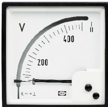
2EQ Double voltmètre composé de deux systèmes à aimants mobiles mutuellement indépendants avec échelle commune. Le point de rotation des deux systèmes est au coin en bas à droite.
