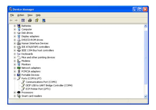
21. 插入正确的通讯端口编号, 然后单击确定。
