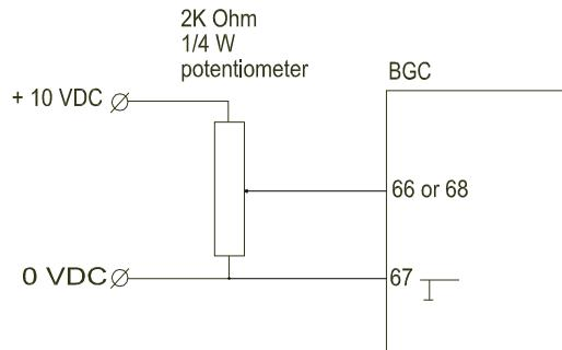
+/-10V input using potentiometer
