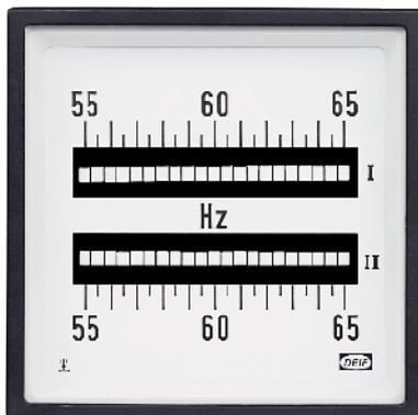
2FTQダブル振動片型周波数計は、1つの筐体に2列のリード線が取り付けられ、交換可能なスケールが備わっています。
