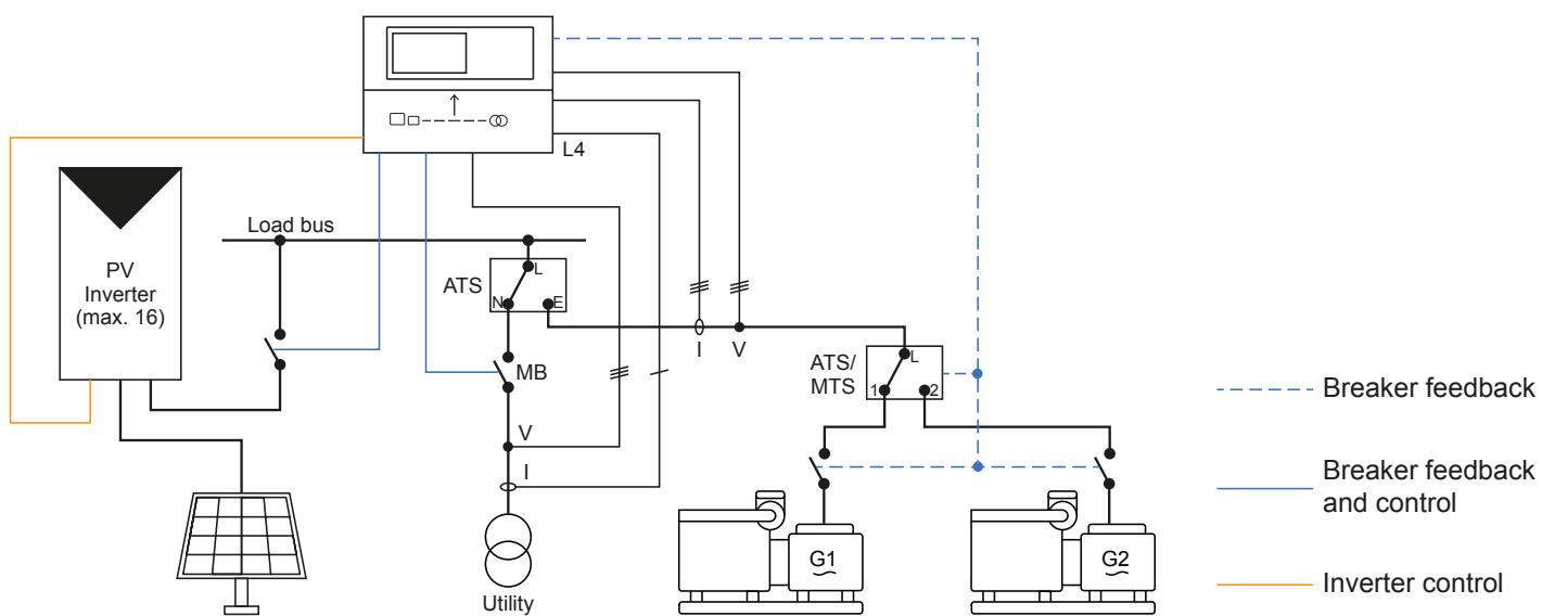
**备注** 将数字量输入和 M-Logic 用于 ATS 和发电机组断路器的反馈。
