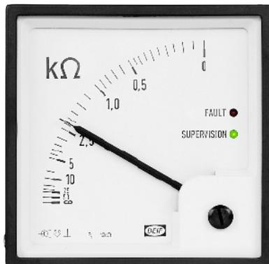
El ADL-111Q96 se emplea para supervisar la resistencia de aislamiento entre una red de distribución eléctrica aislada y un cable de tierra/seguridad. El monitor de aislamiento se emplea en redes de corriente continua (DC) para tensiones de 24, 110 o 220V DC. El ADL-111Q96 dispone de una salida de relé con consigna ajustable y puede configurarse bien a NE (normalmente energizada) o ND (normalmente desenergizada).
