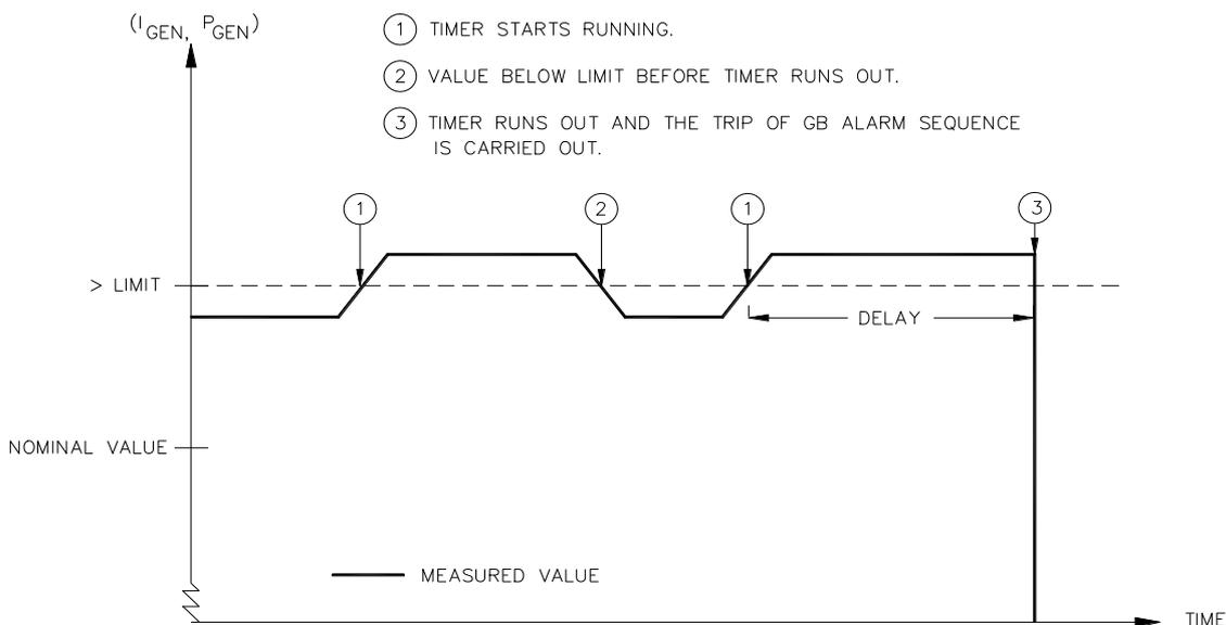
**La surveillance et la protection de générateur/alternateur attelé sont opérées selon le principe de temps défini.**
