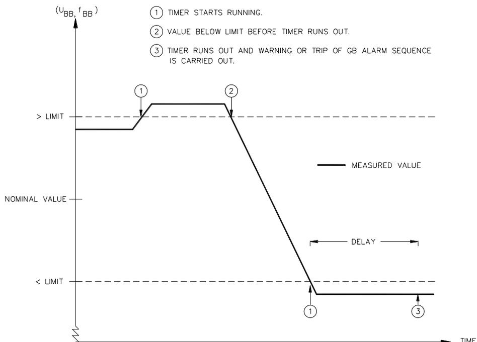
**Les fonctions de surveillance et de protection du jeu de barres/jeu de barres d'alternateur attelé fonctionnent selon le principe de temps défini**
