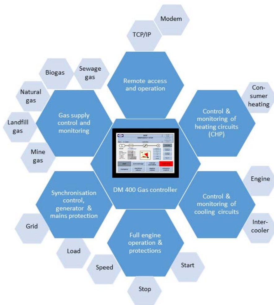
图 1：DEIF 全集成燃气发动机和 CHP 控制系统
