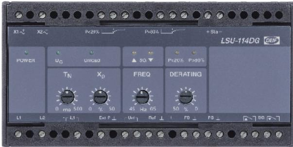
DEIFのUni-line負荷分散ユニットLSU-114DGは、自動開始/停止出力を含む負荷分散を発電機間で行い、電子ポテンシオメーター（EPQ96-2またはEPN-110DN）から調速機へのインターフェイスを提供します。
